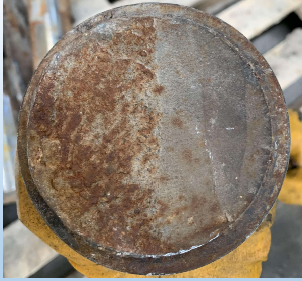
Yorulma nedeniyle kırılmış ankastre kirişe ait kırılma yüzeyi
